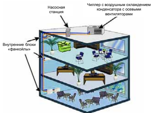
Рис.1 Принципиальная схема системы «чиллер-фанкойл»
